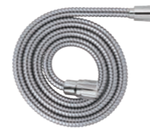
BF437V NEW 帶真空破除器花灑軟管 600 軟管附真空破除功能，手持花灑使用後，內部殘水自動由下方軟管接頭處排出，花灑不滴濺 * 適用水壓大小 1.5kgf/cm 2 以上
