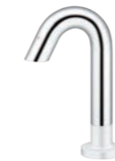
A728 17,000 A728AC 16,000 A728DC 16,000 自動感應龍頭 H: 20.4 H1: 14 L: 10cm 水壓範圍: 1.5~5kgf/cm 2 * 電源選項 1. 水力發電 (免配電) 2. AC式(110V/220V共用) 3. DC式(電池1.5Vx4顆)
