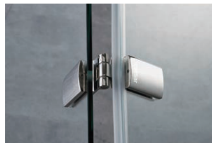
不鏽鋼自由鉸鍊 採用不鏽鋼304材質，異於傳統設計，防水膠條不用分段，防水係數高
