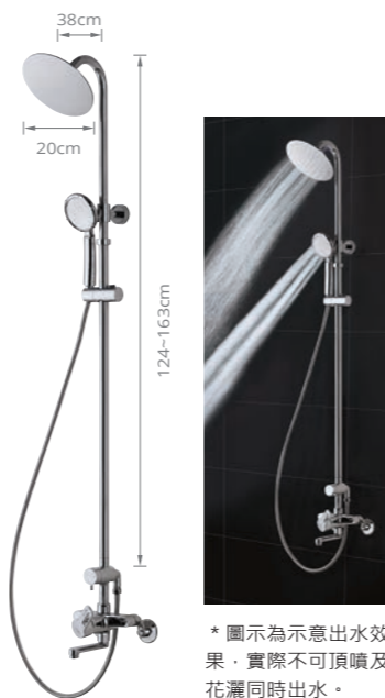
S328C 絲雨淋浴蓮蓬頭 18,200 特色： 1. 出水綿密，大幅降低出水流量，達省水環保功效。 2. 超薄 3.8mm，SUS 鏡面出水面板；搭配輕量化把手，使用無負擔。 3. 若遇雜質阻塞出水孔，請將把手卸下，再以水沖洗搓拭面板即可。 4. 適用 Q105 加裝型置物架。 5. 適用水壓 1 ~ 5 kgf/cm 2 。
